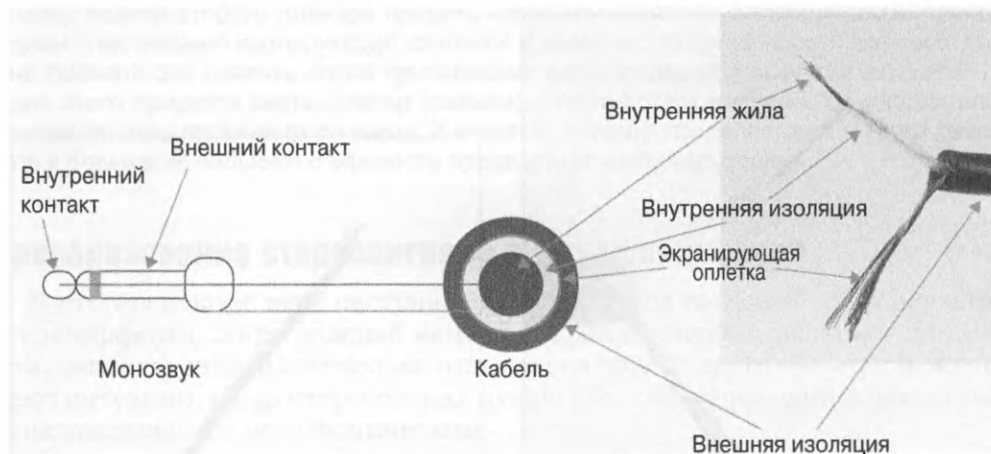
Рис. 9.2. Конструкция штекера
